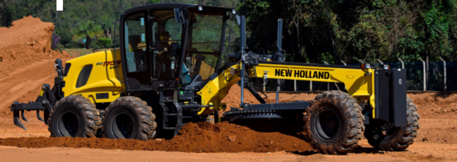
Motoniveladora RG170B ganha novo conjunto de roda/pneu e placa de empuxo frontal, aumentando a força de tração e a pressão da lâmina central
